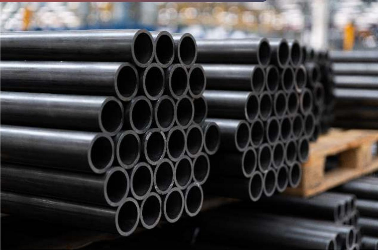
Os Tubos de Aço Trefilados, fornecidos pela Ribermetals, são indicados para construções mecânicas, que exijam precisão dimensional, por isto, uma das principais aplicações é a fabricação de camisa de cilindro hidráulico.
